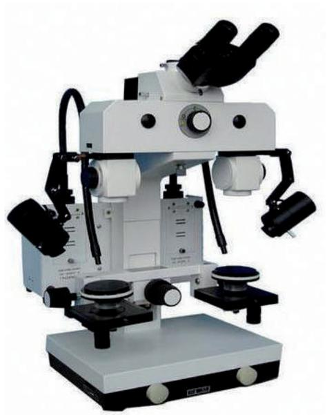
FIGURA 2.7. Microscopio de comparación.
