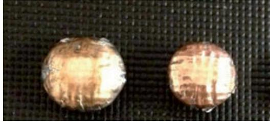
FIGURA 6.8. Marcas del impacto con un chaleco antibalas.
