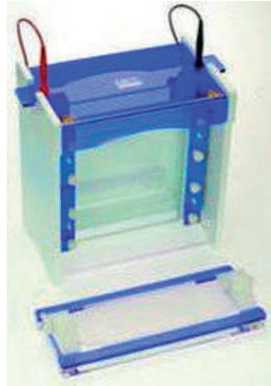
FIGURA 2.5. Cubeta para electroforesis en gel.
