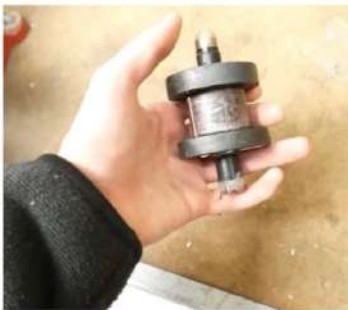
A. Imanes permanentes alrededor de una cavidad hueca.
