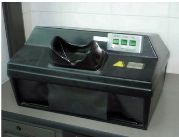
Gabinete de luz ultravioleta: Permite el estudio comparativo simultáneo de documentos.
