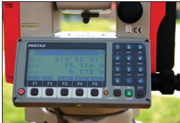
Estación total para levantamiento topográfico.
