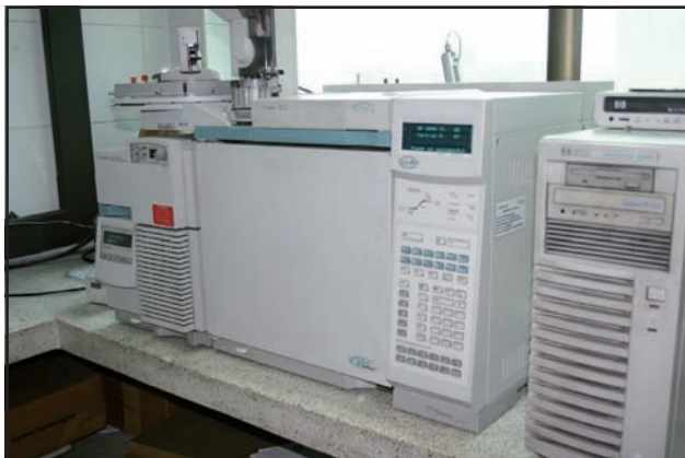
Cromatógrafo de gases acoplado a detector de masas.
