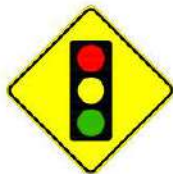
PROXIMIDAD DE SEMÁFORO
