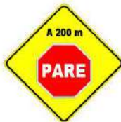
PROXIMIDAD DE SEÑAL RESTRICTIVA (Pare)
