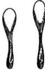
Figura 54. A 10 cm de altura inclinación de 45 grados: forma de raqueta, acumulación y abultamiento en la parte inferior y decoloración en la superior.
