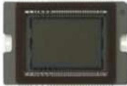
2. *Un sensor de imagen:* El material fotosensible, que en las cámaras analógicas era el negativo, en las cámaras digitales se transforma en un sensor digital compuesto por píxeles. Son los que se encargarán de retener la imagen.
