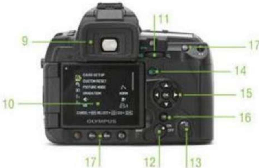
9. El visor óptico. Característica fundamental de las cámaras réflex. A través de él se nos ofrece mucha información sobre la toma y los parámetros que estamos usando.
