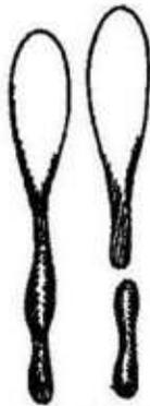
Figura 55. Inclinación 60 grados, a 10 cm de altura; forma de raqueta y lágrima, acumulación y abultamiento en la parte inferior y decoloración en la parte superior.
