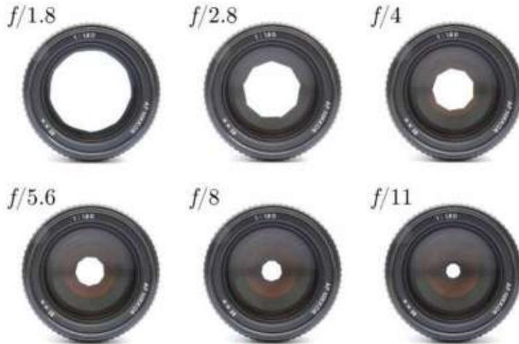
estás dividiendo por dos la cantidad de luz que entra a través del objetivo. Y por el contrario, cada paso hacia abajo que des en la escala, significa que estarás multiplicando por dos la entrada de luz respecto al paso anterior. (Por ejemplo  $f/8$
