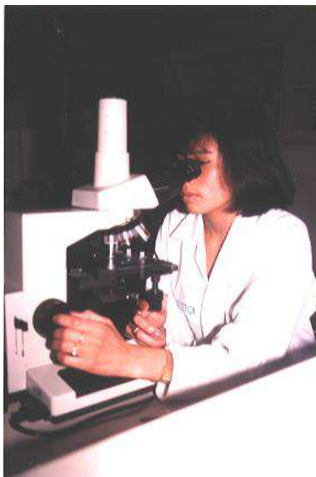
Foto N° 184.- Microscopio que permite observar estructuras tisulares hasta 2500 aumentos.
