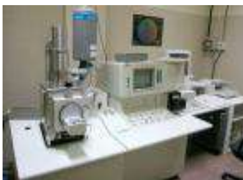
Foto N° 38.- MICROSCOPIO ELECTRONICO DE BARRIDO CON ANALIZADOR DE RAYOS-X, para el estudio de fibras de papel, fibras textiles, metales y aleaciones, minerales, concentrados, pinturas, restos de disparo por arma de fuego, billetes, tintas, cruce de trazos en documentos.
