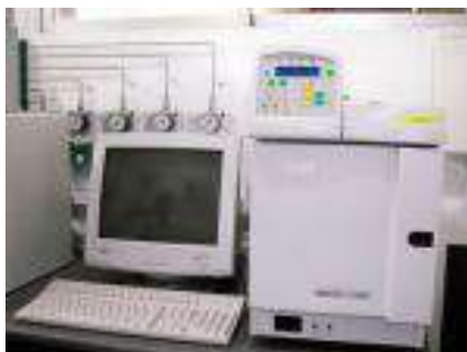
Foto N° 54.- Cromatógrafo de Gas 5880 Serie II con inyector automático. Analiza drogas (cocaína, marihuana, opio, benzodeazepinas, fenotiacinas y metabolitos.
