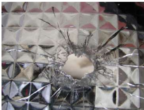
Foto N° 63 .- Fracturas radiales y concéntricas en vidrio en cristales.
