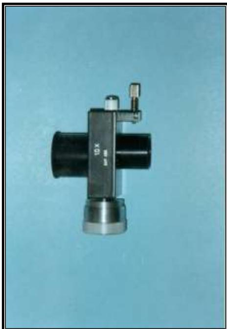
Micrómetro que se coloca en el objetivo del microscopio modelo KF2700
