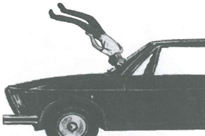
FIGURA III.13. Fase de choque o impacto secundario. El peatón, como consecuencia del impacto primario, pierde el equilibrio y es proyectado hacia la parte superior posterior del vehículo, causándole lesiones, principalmente en la cabeza, con el parabrisas.
