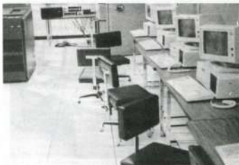
Figura 217. Un aspecto del Centro de Procesamiento Electrónico, que cuenta con un equipo CYBER 930-11, compuesto de: un procesador central 32 MB, una unidad de cinta magnética 18006350 BPI, una unidad de disco con dos adaptadores, seis impresoras de 500 líneas por minuto y una consola de operación que controla en forma directa todo lo relacionado con el equipo central y los periféricos.
