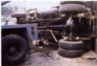
H. Se observa toda la parte inferior del vehículo tipo volvo, el cual se halla sobre un sujeto de obra metálica que está sobre el asfalto; las bombas de aire de los frenos del camión están dañadas, los neumáticos posteriores derechos se observan sencillos y en mal estado de conservación, además se observan roturas por la pérdida de aire de la banda de los frenos, lo cual se deduce por la fuerza de rozamiento que presentan los neumáticos delanteros.
