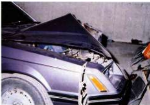
C. Chocho directo en acorreo: se aprecia desplazamiento de la consola y cefeo, radiador y ventanador debido a los paros del motor.
