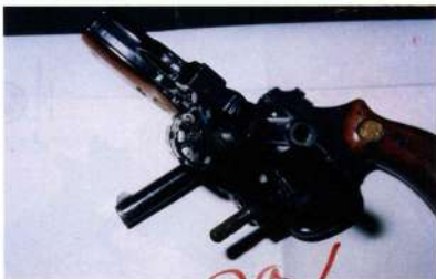
Figura 7.15. Pasa de Smith & Wesson. Vista del cilindro y el cerrojo.
