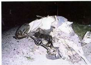
C. Acorchamiento de la parte posterior del vehículo.
