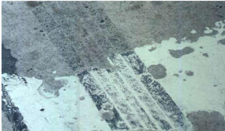
En realidad, el vehículo comienza a deslizarse antes del bloqueo, dado que el frenado progresivo origina un resbalamiento ( $S$ ) sobre el piso de las ruedas debido a la inercia del vehículo ocasionada por el retardo de la velocidad angular de sus ruedas:
