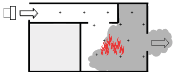
Imagen 122. Esquema en planta de una ventilación en presión positiva ofensiva. El flujo creado por el ventilador atraviesa el foco de incendio
