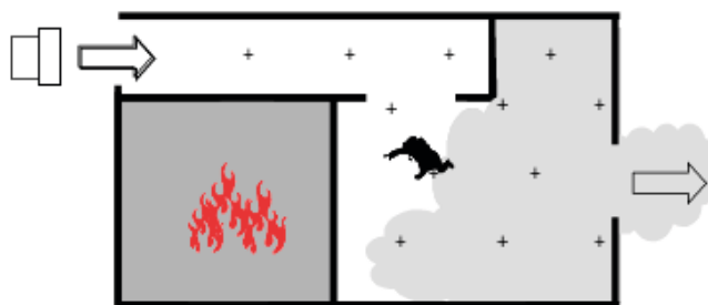
Imagen 119. Esquema en planta de una ventilación en presión positiva defensiva. El flujo creado por el ventilador no atraviesa el foco de incendio
