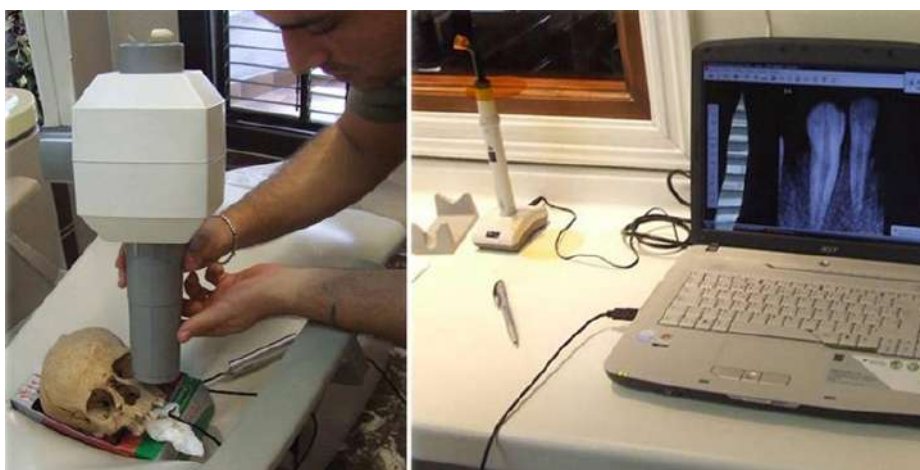
Figura 11. Ejemplo de radiografía digital directa con captador de imagen (Foto Stefano De Luca y Fernando Navarro).
