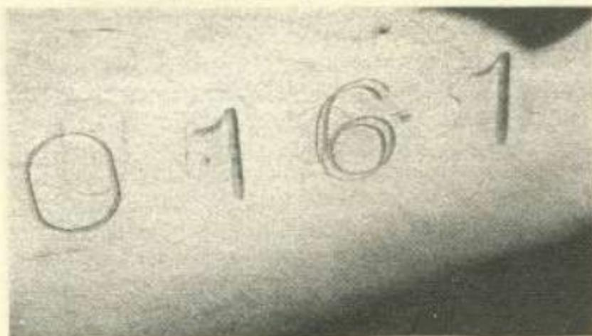
Fotografía que muestra el resultado del examen químico metalográfico, son los indicios latentes (huellas) de una identificación alfanumérica fue ligeramente limada y se grabaron caracteres totalmente diferentes sobre los originales.
