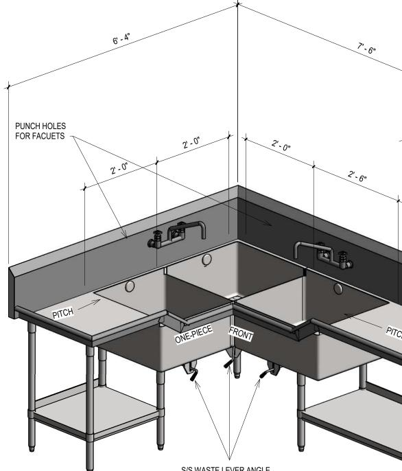
S/S WASTE LEVER ANGLE BRACKET (FULLY WELDED)
