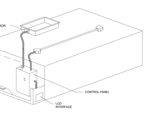
TYPICAL HOOD CONTROL PANEL INSTALLATION
