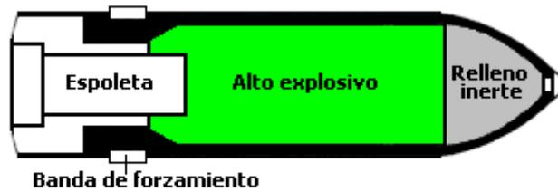
Figura 24.4. Componentes básicos de un proyectil HESH
