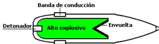
Figura 20.4. Esquema de un proyectil de carga hueca
