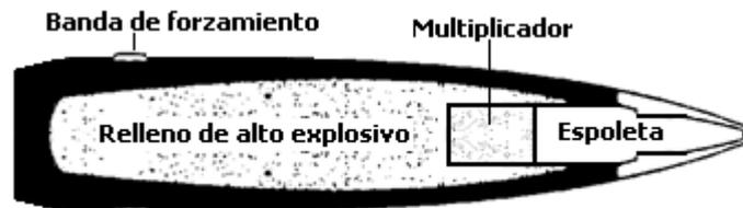
Figura 5.4. Proyectil rompedor. Componentes básicos
