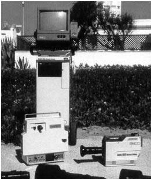
Figura 36.6. Video de alta velocidad HSV-400
