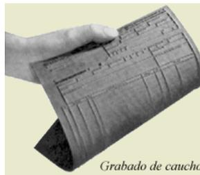
**3.1.1.3. Offset Seco.** No es la eliminación del agua en el offset<sup>10</sup> y no tiene relación con la litografía<sup>11</sup>. Se sustituye la plancha de aluminio en el cilindro porta plancha de la impresora por una de fotopolímero, con la superficie grabada en altura tipográfica. Es tipografía indirecta, pues se sigue usando la mantilla. El sistema reúne las ventajas de ambos sistemas: mayor velocidad, colores firmes y falta de presión en el dorso.
