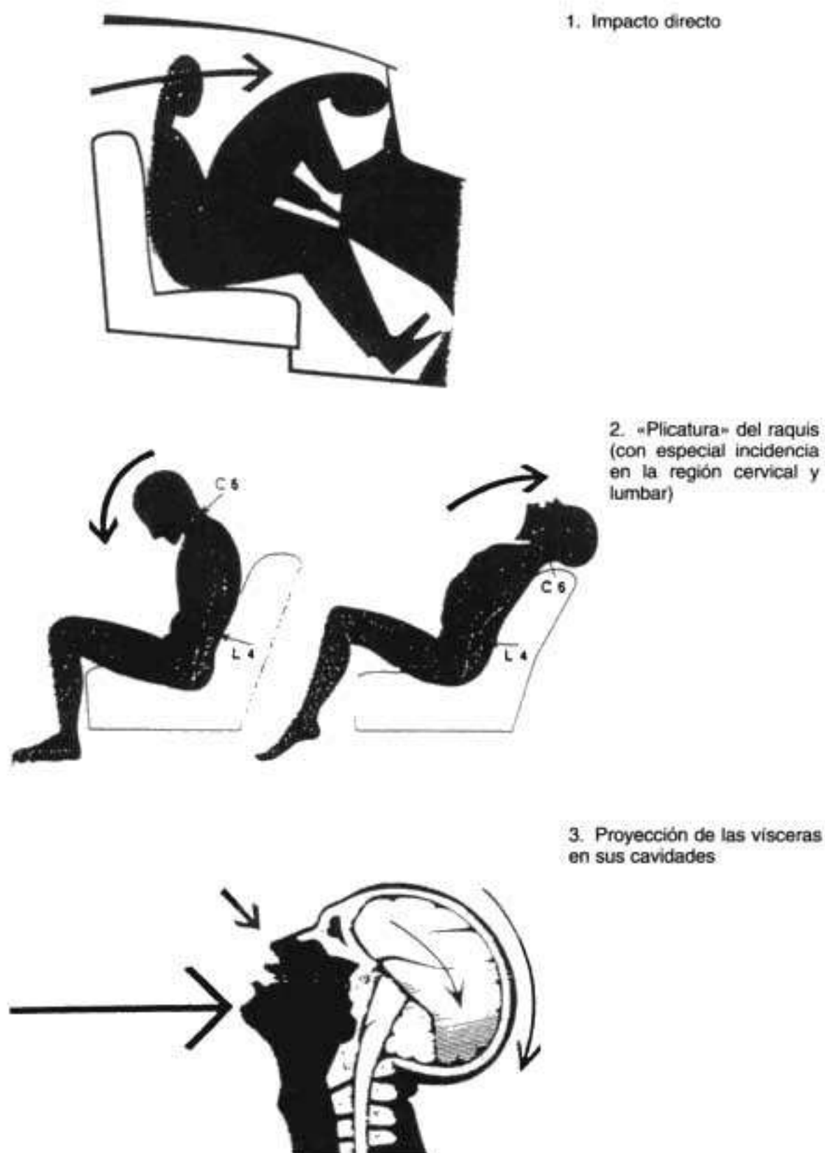
Figura 4.10. Descripción simple de tres mecanismos de producción de lesiones en los accidentes de tráfico. (Ref., desconocida.).
