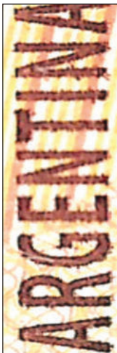
Impresión calcográfica y plana
