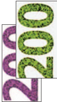
Tinta OVI cambia del morado a verde
