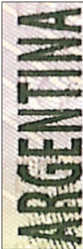
Impresión calcográfica y plana
