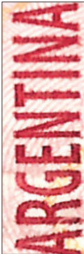
Impresión calcográfica y plana
