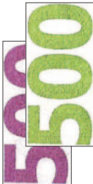
Tinta OVI cambia del morado al verde
