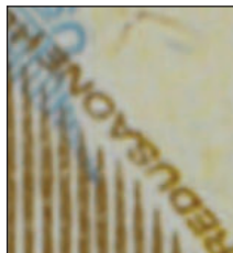
Impresión Intaglio, tipográfica y offset
