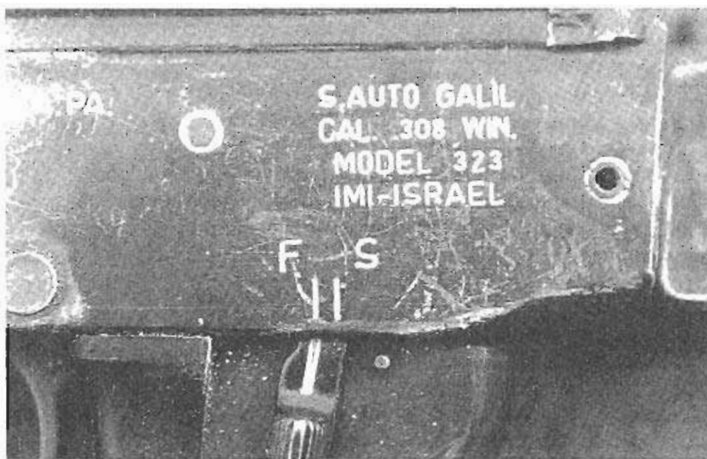
Fusil semiautomático Galil, con su palanca selector de seguro y disparo
