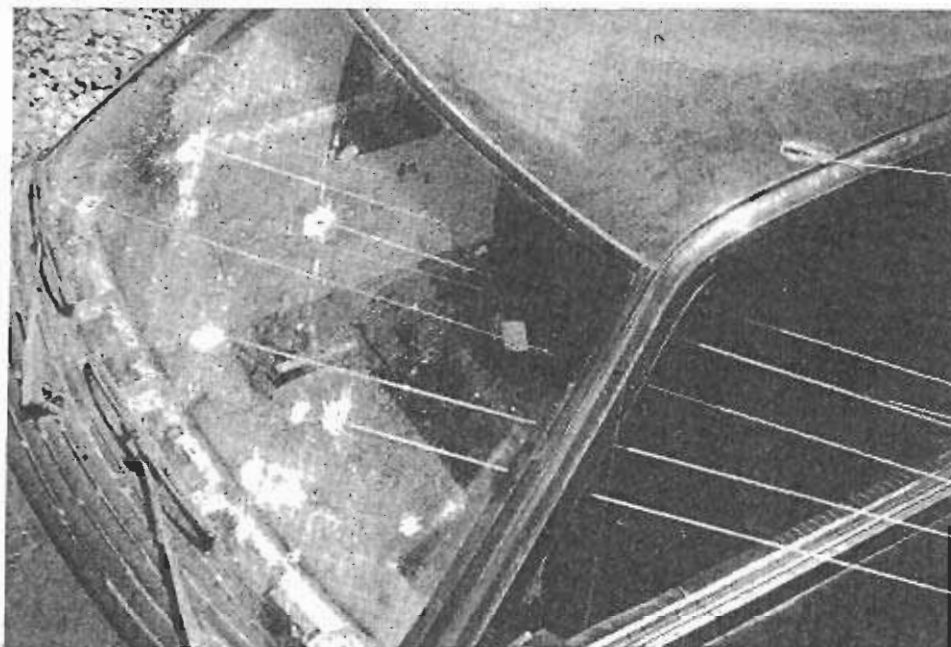
Acercamiento de las trayectorias de los proyectiles sobre el cristal parabrisas
