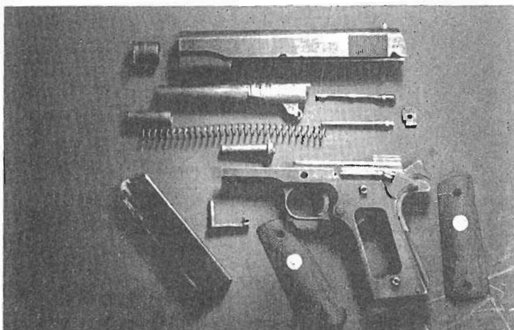
Despiece de una pistola semiautomática
