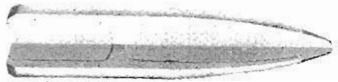
Vista interna del proyectil Nosler Partition
