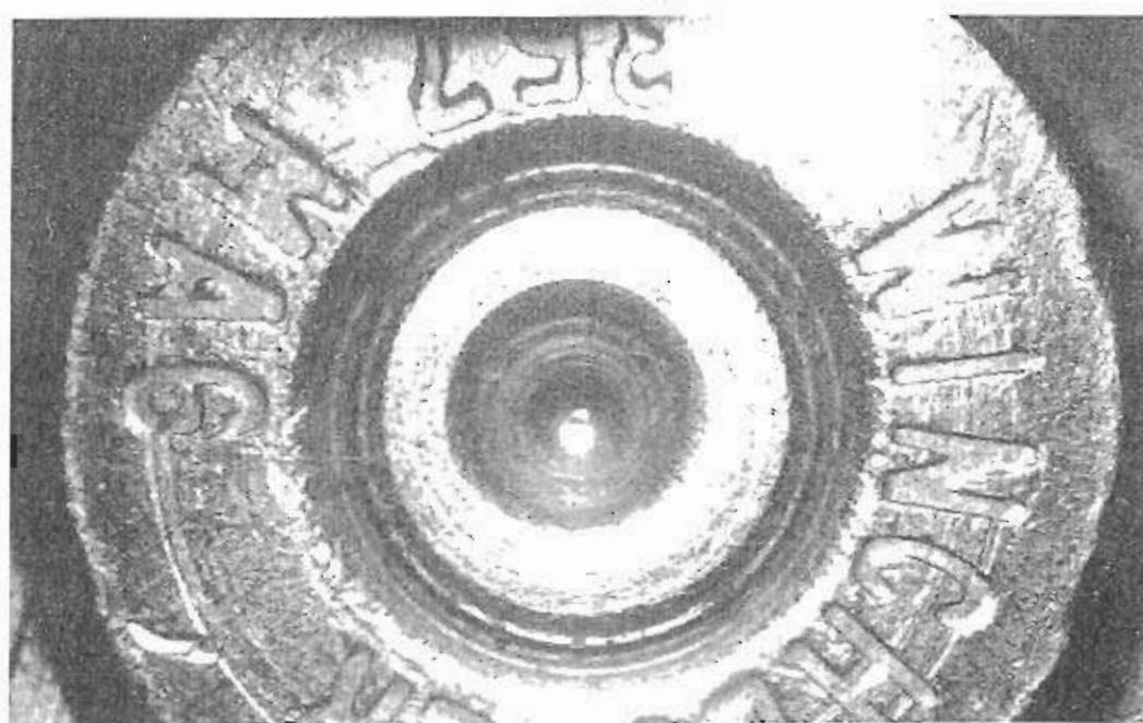
Marcas de obturador circulares
