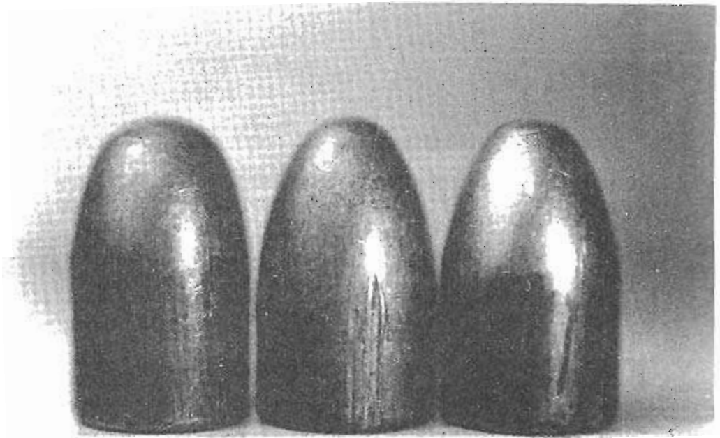
Orientación del rayado en los proyectiles
