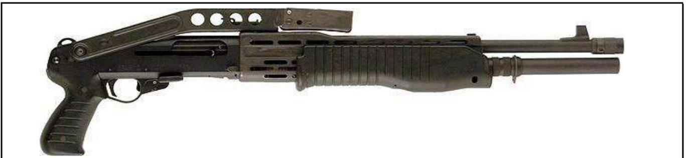
Imagen 85. Arma de corto alcance - baja velocidad, escopeta SPAS-12 Cal. 12.
