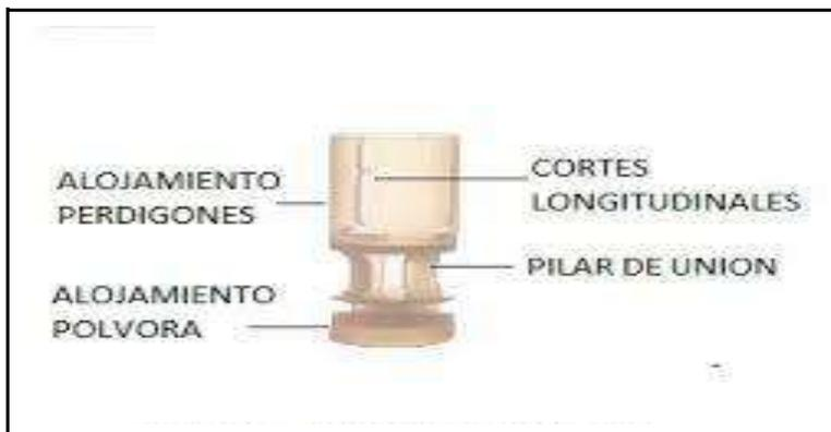
*Imagen 22. Partes de un taco.*
