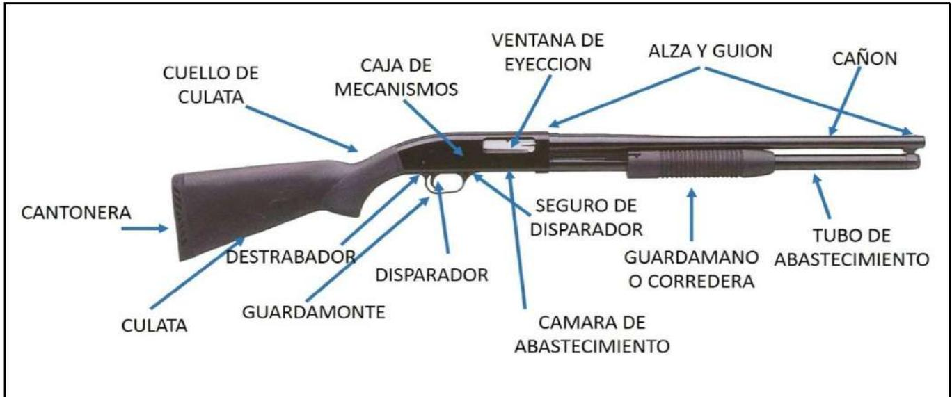
Imagen 123. Partes principales de una escopeta.
