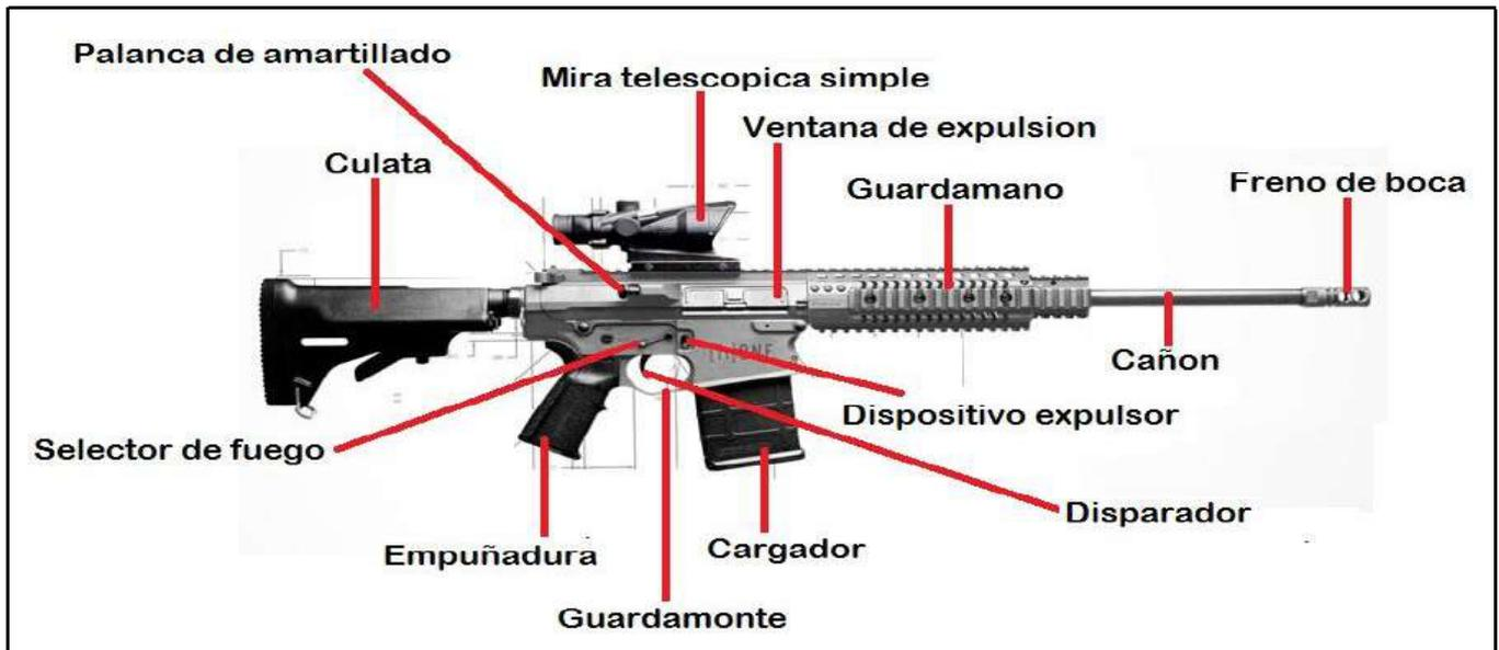
Imagen 121. Partes principales de un fusil.
