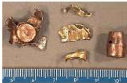
FOTO 46 Proyectiles 9 mm deformados tipo punta perforada con cortes. Nótese en el centro la camisa desprendida en 3 partes.
