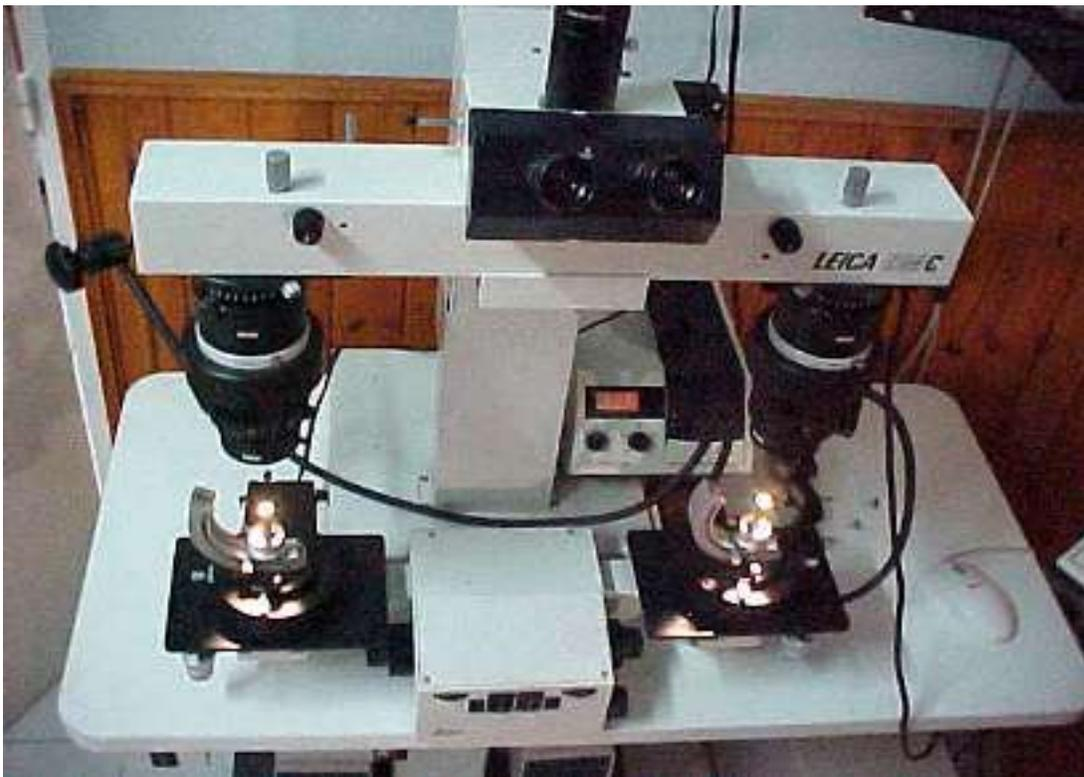
**FOTO 73 MICROSCOPIO COMPARADOR MARCA LEICA**
