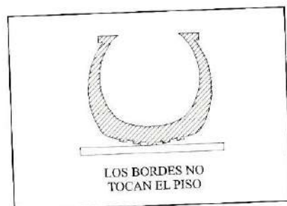
Corte de neumático con sobrepresión
