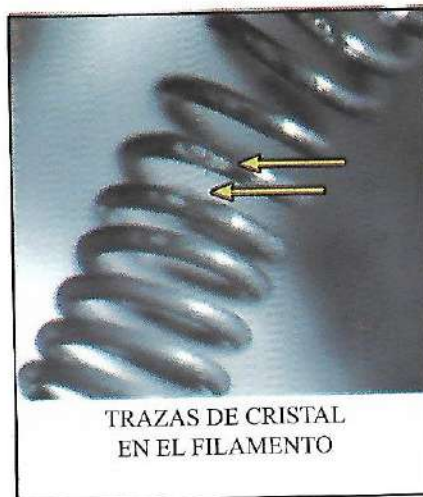
CRISTAL DEPOSITADO SOBRE EL FILAMENTO. VISTA CON MICROSCOPIO DE BARRIDO
