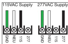
Figure 4: P115/277 wiring
